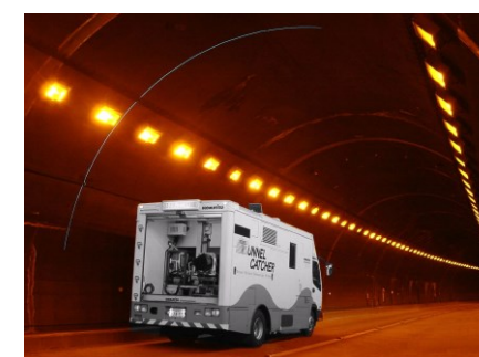
レーザーによる ひび割れの検出
