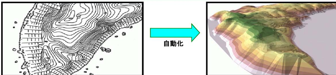
紙地図やDXF形式CADデータからの高解像度の標高データ構築技術の開発により、風車近傍のわずかな地形起伏に起因した地形乱流(風の乱れ)の影響を忠実に再現
