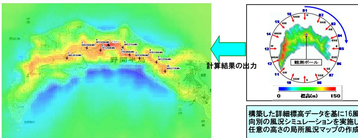
構築した詳細標高データを基に16風向別の風況シミュレーションを実施し、任意の高さの局所風況マップの作成
