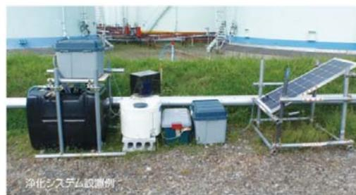
※不飽和帯の浄化は、有孔ホースにより地表部に散水し、3Nを自然浸透させます。
