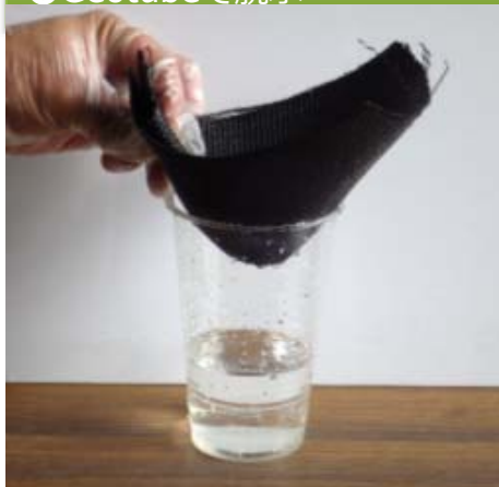
③ Geotubeで脱水
