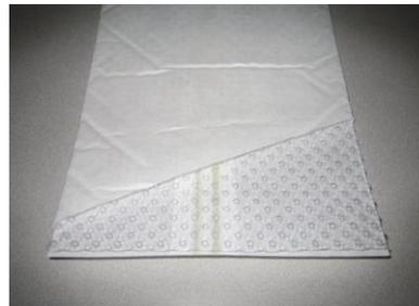
写真-2 水平ドレーン(BSBドレーン)
