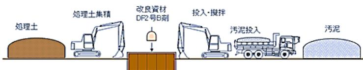
産業廃棄物(汚泥)を、場内に設置した鋼製改良水槽において造粒固化処理+養生後コーン指数測定試験及び土壌環境基準分析(溶出・含有試験)を実施⇒場内再利用
