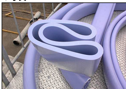
〔施工前のオメガライナー〕
