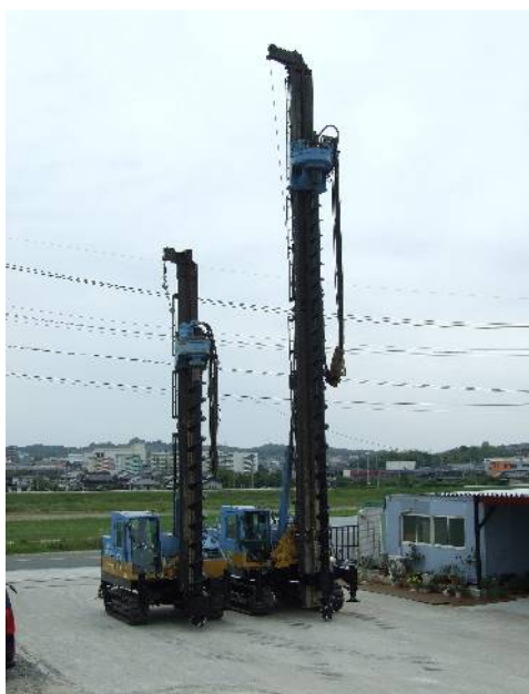
スーパーロックEx施工機 左20t級 右35t級
