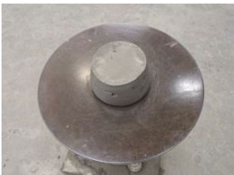
フロー試験(静置)(107mm×105mm)
