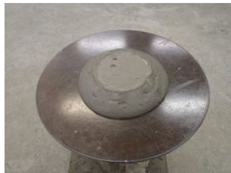
フロー試験(15打)155mm×155mm
