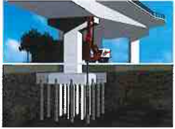
既設構造物基礎の補強増し杭
