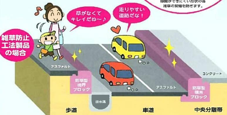
これまで主に歩車道境界ブロックについて説明していますが、当然「路肩」、「開渠」、勾配可変側溝等の側溝類にも応用できます。また、鉄筋コンクリートL型やその他多くのアスファルトやコンクリートと接続する部分にも応用できます。
