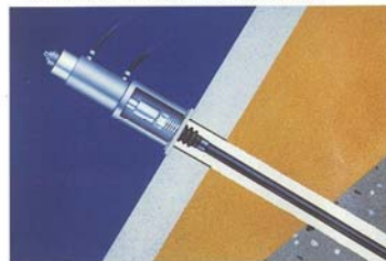
5. 緊張 グラウトが所定の強度に達した所で、緊張作業を行います。プレート背面防食のために、ストッパーシースを取付け、緊張力とアンカー頭部の変位を確認しながら緊張作業を行います。
