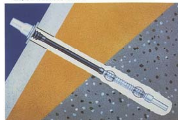
6. 頭部処理・完成 定着されたアンカー頭部にアンカーキャップを取付け、防錆処理を行ない作業が完了します。
