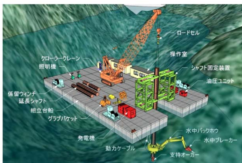
図1 T-iROBO UW の全体構成
