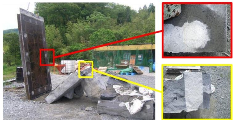
実験体落下後の鉄板状況
