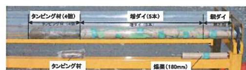
模擬の爆薬による遠隔装填システムによる密装填状況
