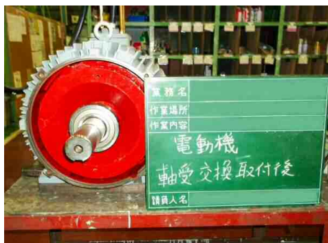
電動機軸受交換
