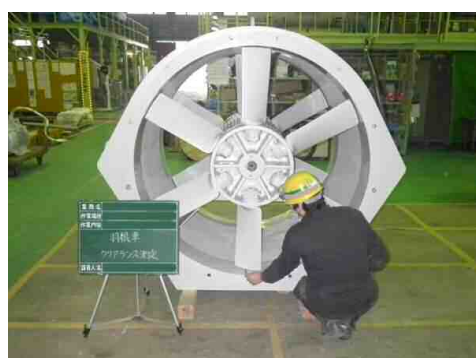
羽根車チップクリアランス測定
