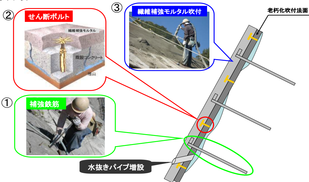
図-1 ニューレスプ工法模式図
