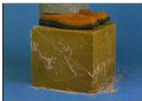
写真二 連続繊維補強土
