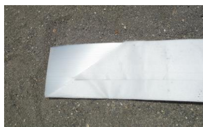
写真-1.2 鉛直ドレーン(生分解性)
