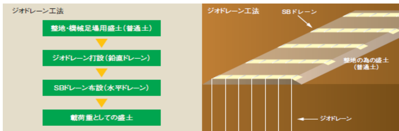
図-1 ジオドレーン工法施工フロー
