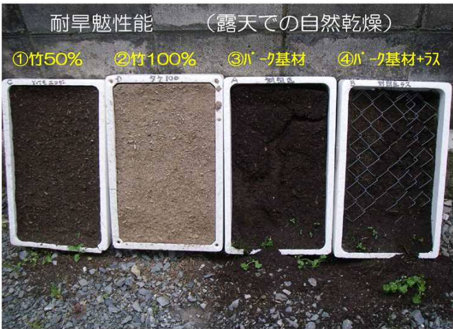
降雨による基盤材の侵食試験結果
