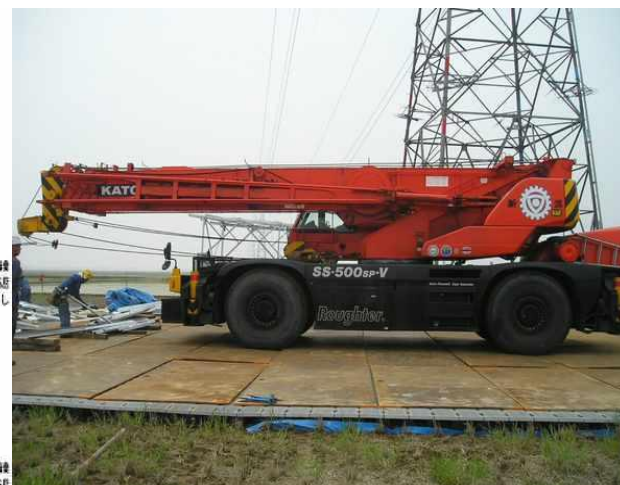
写真② 仮設道路供用50tラフター走行
