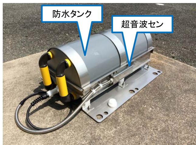
写真-1 超音波式流速・SSI計外観(側面)
