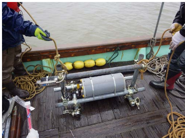
写真-3 超音波式流速・SSI計の現地設置作業状況
