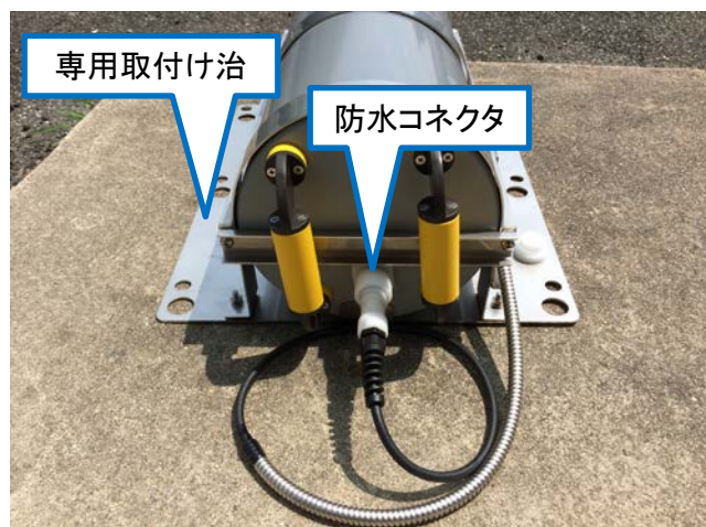
写真-2 超音波式流速・SSI計外観(正面)
