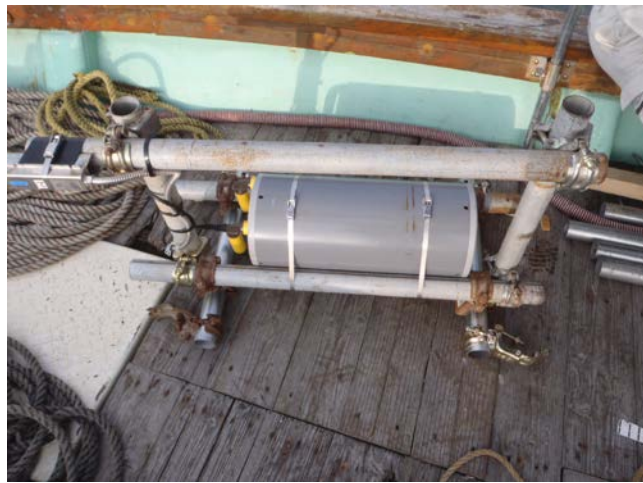
写真-3 超音波式流速・SSI計の現地設置作業状況
