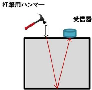
ひび割れ等の損傷がない場合、衝撃波は構造物底部に反射し、受信器に到達する。
