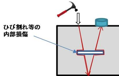
ひび割れ等の内部損傷がある場合、衝撃波は損傷部を回避した経路を通るため、内部損傷がない場合に比べて伝達距離が長くなる。このため、内部損傷が多ければ多いほど伝達距離が長くなる。
