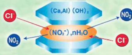
SSI工法が従来の工法と決定的に異なるのは、鉄筋およびその周辺の塩分を低減し、鉄筋の腐食を長期的に抑止することです。
