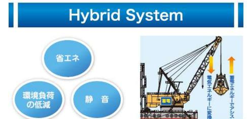
グラブ巻き下げ時に発生するエネルギーを蓄え、グラブ巻き上げ時に利用します。燃料消費量を25%～30%低減できるとともにCO<sub>2</sub>などの排出ガスも大幅に削減できます。
