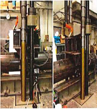
●継手部耐力確認試験
