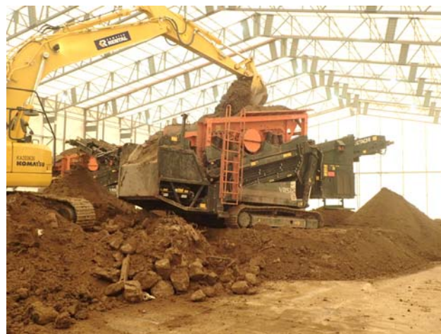
写真5 自走式振動スクリーンによる選別
