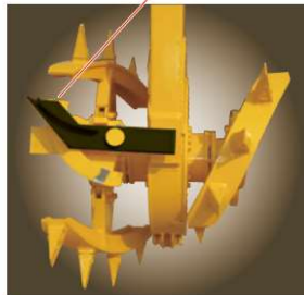
写真-1 リボンスクリュー型攪拌翼
