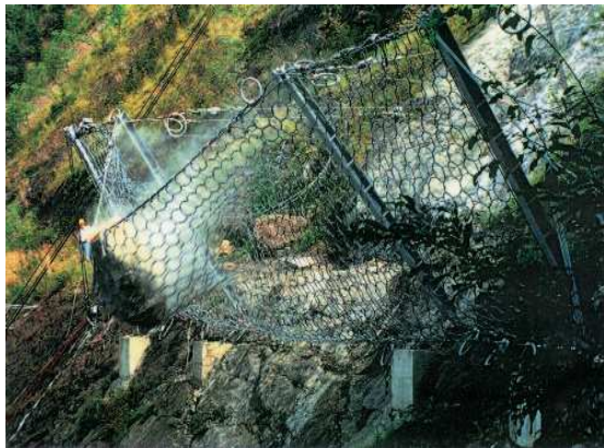
実物大落石実験RXシリーズ (250~30,00kJ) 対応
