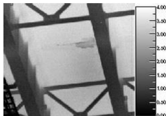
図-2 浮き撮影例(橋梁床版下面)
