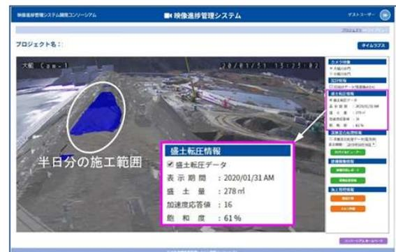
図-2 自動走行中の制御画面【施工・品質管理のDX化】
