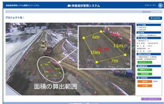
図-3 盛土品質モニタリング画面【施工・品質管理のDX化】
