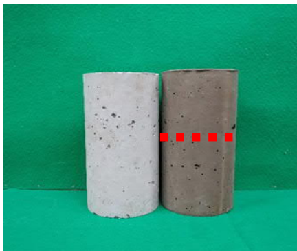
写真3 普通コンクリート(左) リグニンクリート(右)
