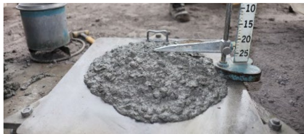
図-5 ポリマーコンクリートスラブ試験状況
