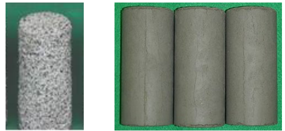
図-4 耐酸性試験後供試体写真
