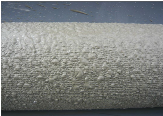
図-4 注入後のパッカー表面
