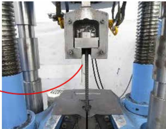
万能材料試験機による引張試験
