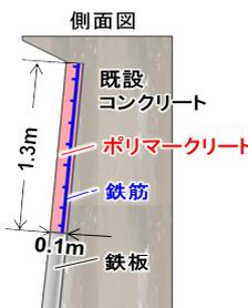
図-9 補修断面図
