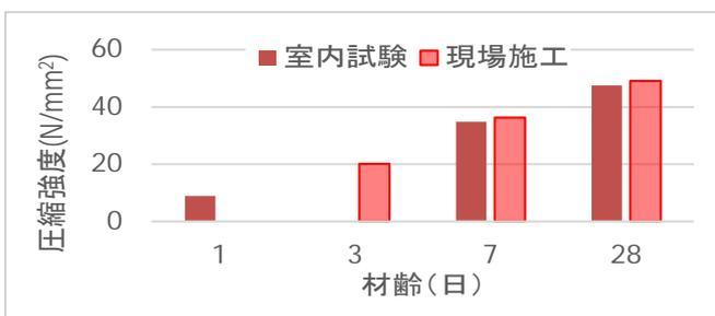
図-7 ポリマークリート圧縮強度試験結果
