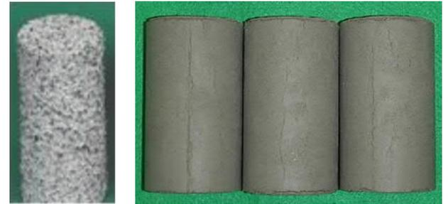
図-4 耐酸性試験後供試体写真
