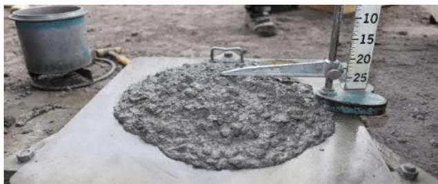
図-5 ポリマークリートスランプ試験状況
