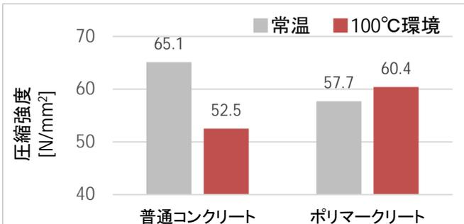
図-3 100°C環境暴露後の圧縮強度
