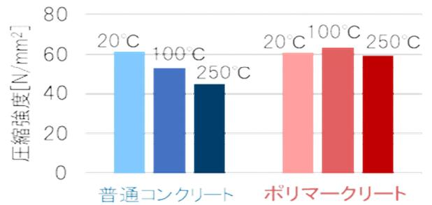
図-2 250°C加熱後の圧縮強度
