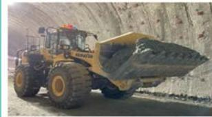
自動ホイールローダを開発し、切羽に堆積した岩砕のすくい取りからホッパへの投入までの一連の作業を完全自動化しています。
