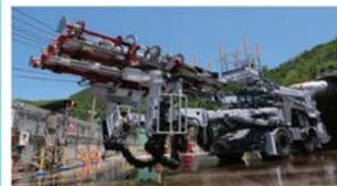
穿孔位置への誘導から穿孔、モルタル注入、ボルト挿入までの一連作業を、設定した所要数量、間隔で自動で施工します。
